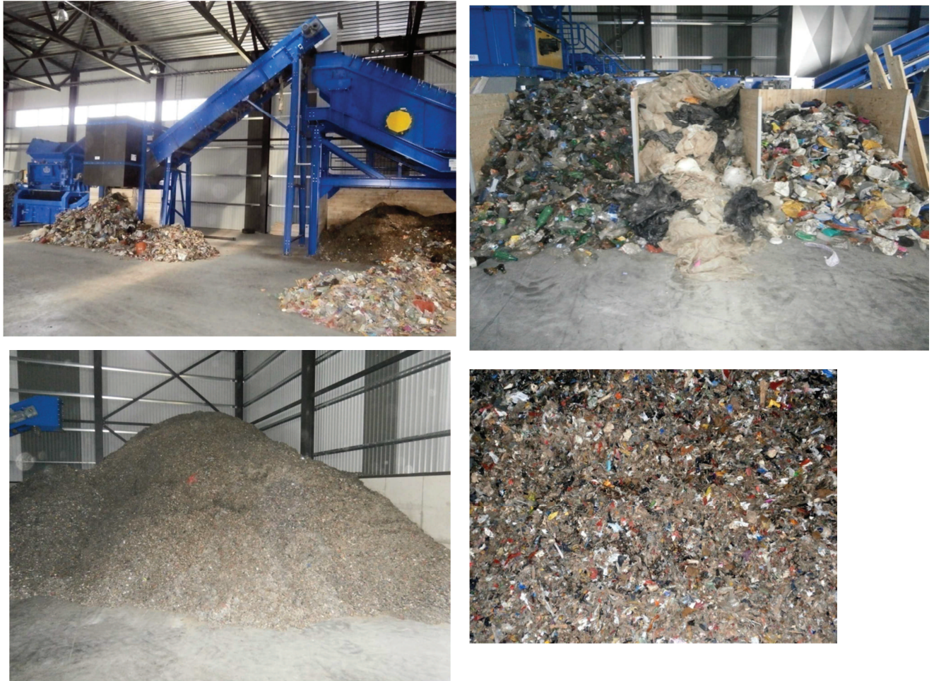
Obrázok 7 – 10: „Suchý“ podiel – separácia druhotných surovín a výroba RDF paliva z MSW.
