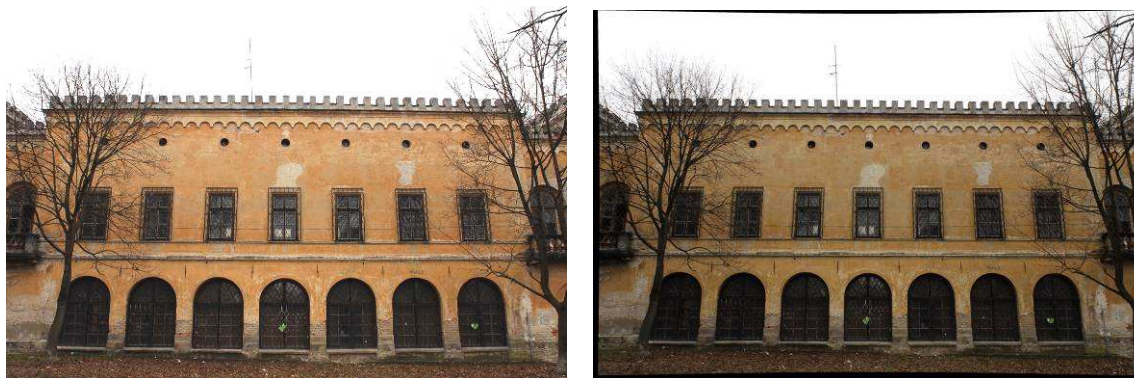
Obr. 1 Snímka s distorziou objektívu (vľavo) a prekreslená snímka bez distorzie (vpravo)
