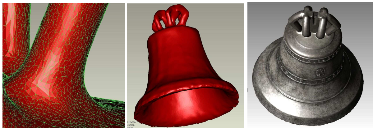
Obr.7: a) Časť polygonálneho model zvona Skrabské b) 3D model zvona Skrabské c) Textúrovaný model zvona Skrabské
