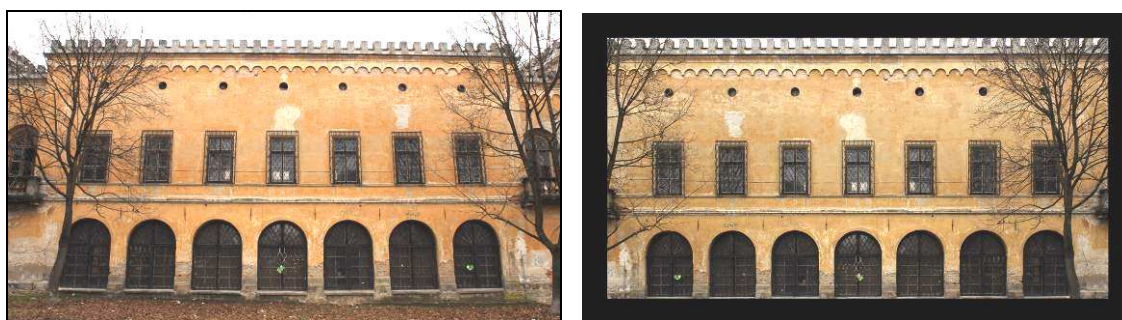
Obr. 2 Originálna snímka (vľavo) a rektifikovaná, bez projektívneho skreslenia (vpravo)
