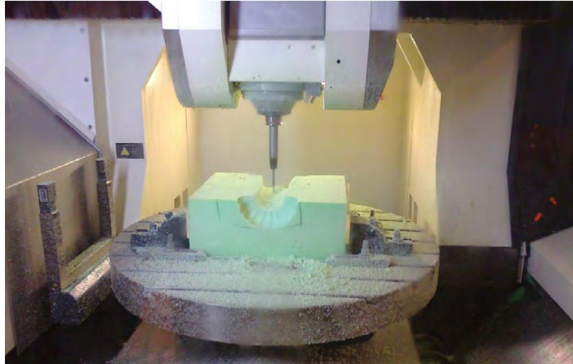
**Obr. 8:** Fotodokumentácia zo zhotovovania formy na 5-osej CNC fréze DMG HSC 105 linear v Centre EXCELENTNOSTI 5 – OSOVÉHO OBRÁBANIA MTF STU, (Zdroj foto: V. Hain, M. Ganobjak, 2012)
