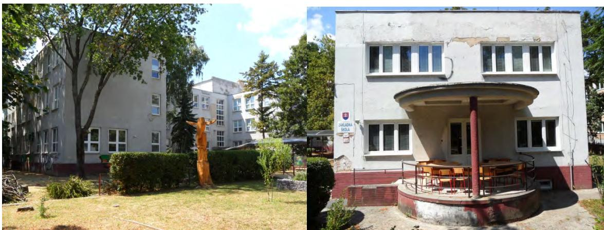
**Obr. 1:** Funkcionalistická národná kultúrna pamiatka, bývalá Štátна meštianska škola v lokalite nazývanej „Číneš“, po čiastočnej obnove okenných výplní výmenou sekundárnych okien na budove školy za plastové výrobky. Vpravo vila riaditeľa po výmene pôvodných okien za plastové tvarové kópie.
