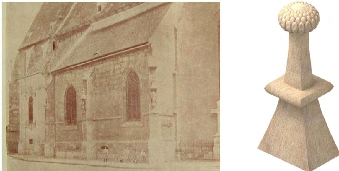
**Obr. 4:** Výsledné odvodenie tvaru resp. novotvaru fiály v 3D modeli vyhotovené pre posúdenie reštaurátorom
