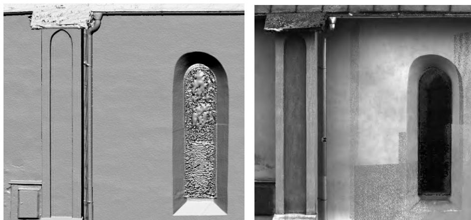
**Obr.2:** 3D model (výstup z 3D fotogrammetrie) vľavo bez textúry, vpravo s textúrou. Je zjavné, že plocha fasády tekonika bola vyhodnotená správne. Dažďový zvod nie je oddelený od plochy fasády – software nedokáže automaticky vyhodnotiť priestor za ním. Šum v zobrazení v okne je spôsobený vloženou jemnou sietkou proti hmyzu, strecha je fragmentarizovaná nazbieranými nečistotami a poškodením krytiny. Snímky z archívov VIA MAGNA s.r.o.
