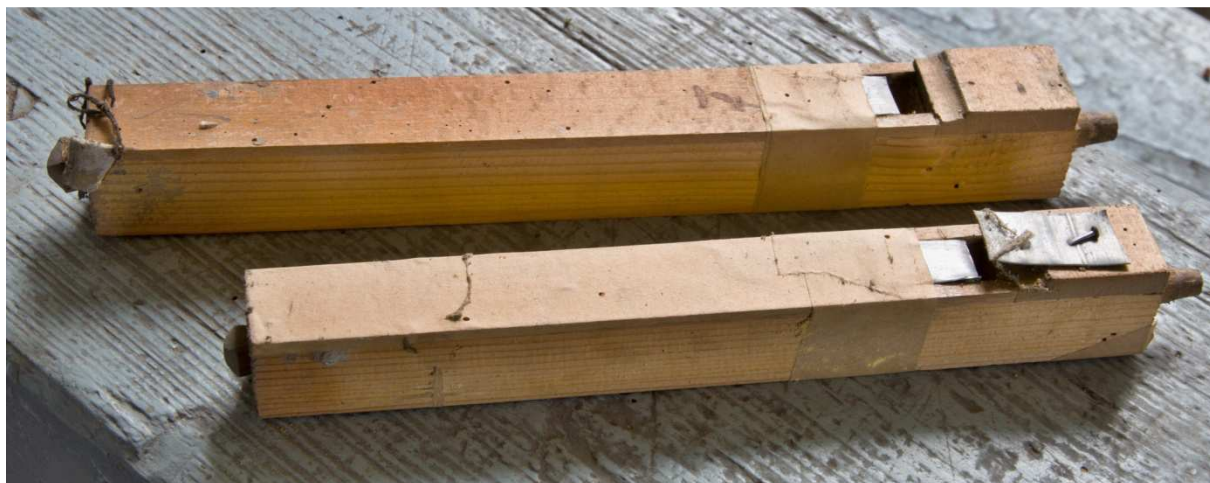
Obr. 1 Poškodené píšťaly v jadrovej oblasti kovovými plieškami a klincami (autor Ing. Maroš Detko)
