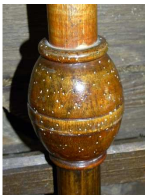
Obr. 21: Rozsiahly výskyt otvorov po drevokaznom hmyze na procesiovom kríži.
