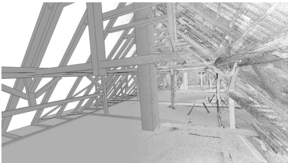
Obr.2: Modelovanie krovu podľa mračna bodov.
