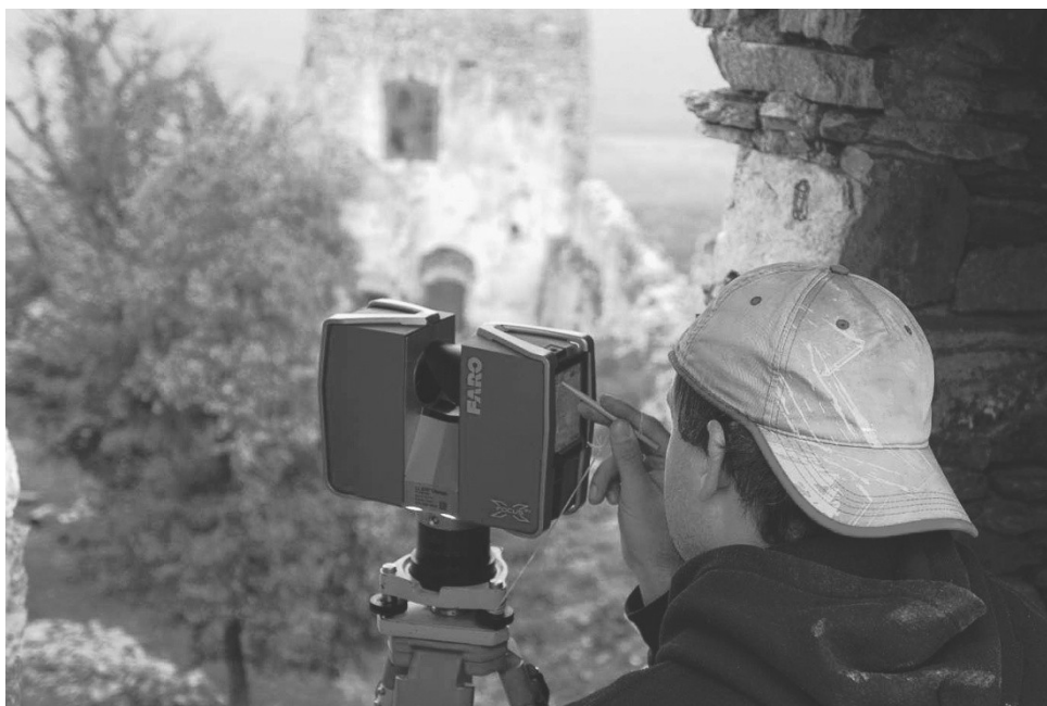
Obr.3: Zber dát v teréne pomocou laserového skenera.
