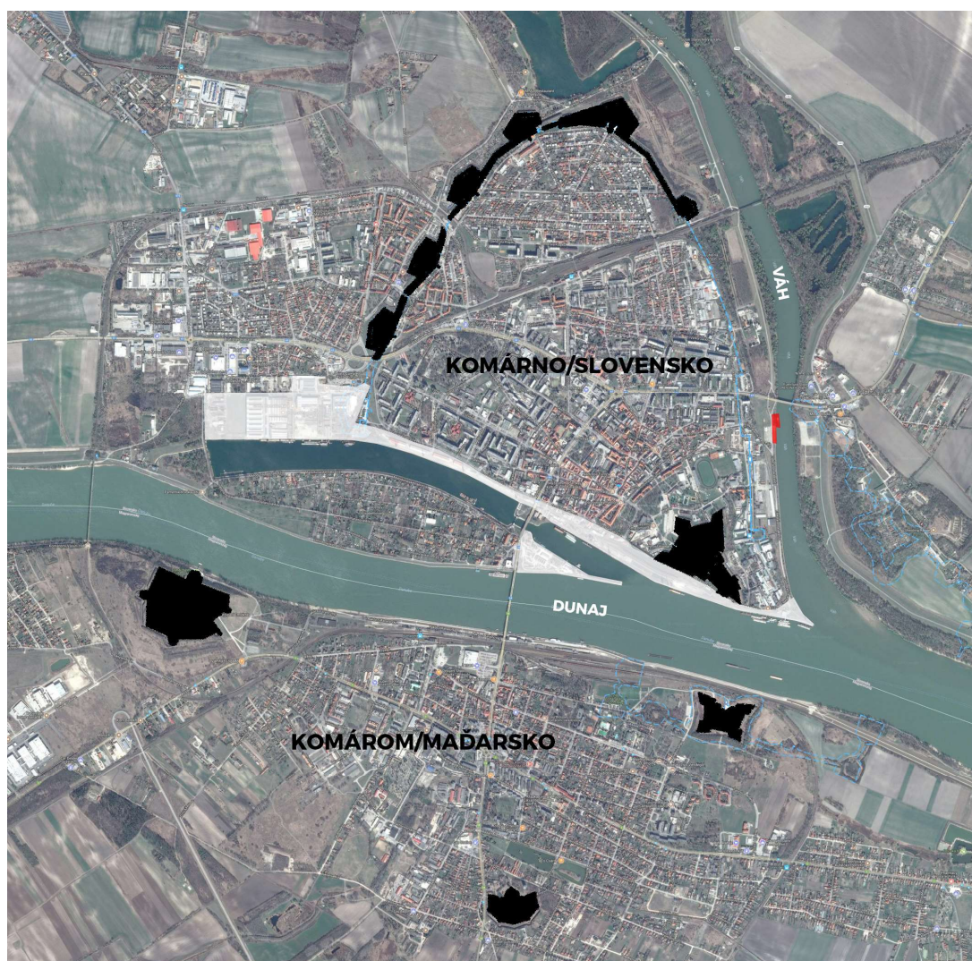
Obr. 8: Súmeste Komárno – Komárom. Systém opevnení na sútoku riek Dunaja a Váhu v Komárne – Komárome vyznačený čiernou farbou (zachované pevnosti a bastiónové opevnenie), svetlomodrou obrysovou líniou (zaniknuté časti opevnenia). Situácia doplnená o prístavné plochy spolu s areálom Starej Lodenice na ostrove a Novej Lodenice na severozápadnej strane slepého ramena Dunaja – plochy vyznačené bielou farbou. Na rieke Váh červenou farbou označený malý osobný prístav. (Poznámka: prislúchajúce nábrežné a prístavné plochy s lodenicami vyznačené len na slovenskej strane v meste Komárno.) [3]
